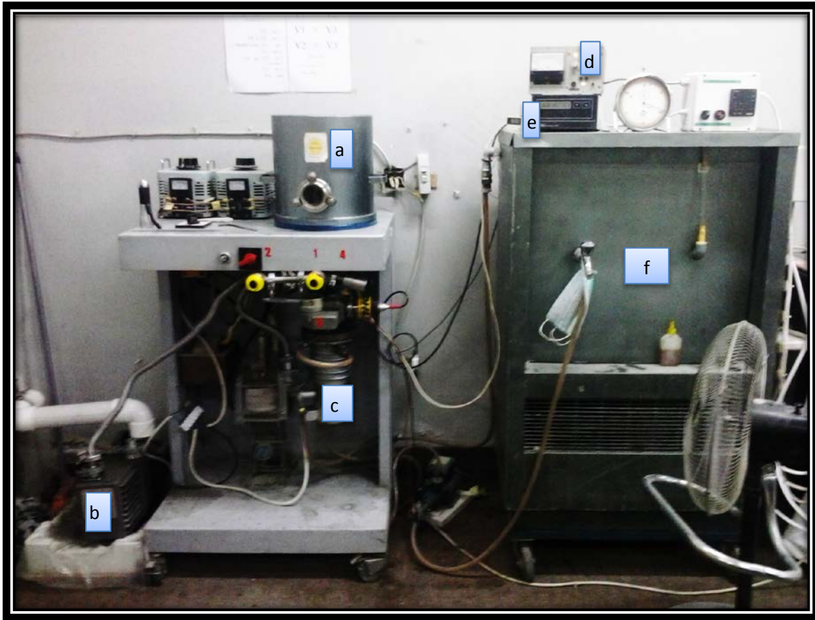
الشكل (3-5) منظومة التبخير المستعملة لترسيب الأغشية واجزائها
